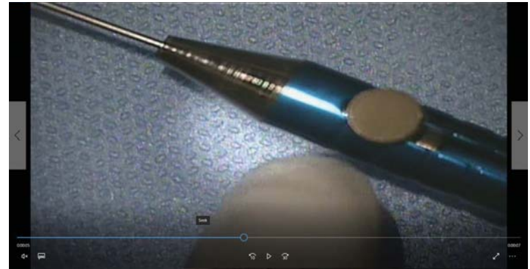
Şekil 8 a-c: a, Yeni dizayn edilmiş yabancı cisim forseps. b, YC forsepsinin ucu açık halde, ucundaki kafes yapısı izleniyor. c, YC forseps el tutacağındaki düğmenin ileri-geri hareketiyle forsepsin uç açıklığı değişir.
