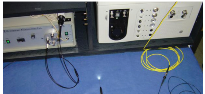
Resim 9: Fiberoptik mikroendoskop aletinin görünümü: CCD kamera, oryantasyon ve fokus lensi, xenon aydınlatma kaynağı, probun santralindeki kanala sokulmuş laser fiberi.
